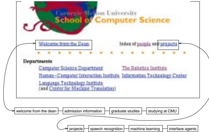
Abbildung 8: WebWatchers interne Beschreibung von Hyperlinks besteht aus dem Anchor-Text und den Interessenbeschreibungen von Benutzern, die diesem Hyperlink gefolgt sind. Wann immer ein Benutzer einem Hyperlink folgt, wird das von ihm eingegebene Interesse zu der Liste des Hyperlinks hinzugefügt.
