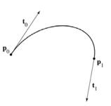
$$\mathbf{p}(t) = \begin{bmatrix} t^3 & t^2 & t & 1 \end{bmatrix} \begin{bmatrix} 2 & -2 & 1 & 1 \\ -3 & 3 & -2 & -1 \\ 0 & 0 & 1 & 0 \\ 1 & 0 & 0 & 0 \end{bmatrix} \begin{bmatrix} \mathbf{p}_0 \\ \mathbf{p}_1 \\ \mathbf{v}_0 \\ \mathbf{v}_1 \end{bmatrix}$$
