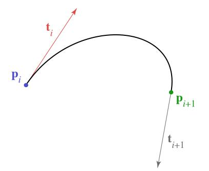
$$\mathbf{f}(t) = \begin{bmatrix} t^3 & t^2 & t & 1 \end{bmatrix} \begin{bmatrix} 2 & -2 & 1 & 2 \\ -3 & 3 & -2 & -1 \\ 0 & 0 & 1 & 0 \\ 1 & 0 & 0 & 0 \end{bmatrix} \begin{bmatrix} \mathbf{p}_0 \\ \mathbf{p}_1 \\ \mathbf{p}'_0 \\ \mathbf{p}'_1 \end{bmatrix}$$
