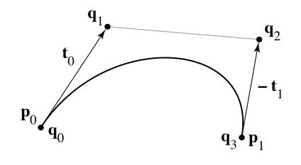
$$\begin{bmatrix} \mathbf{p}_0 \\ \mathbf{p}_1 \\ \mathbf{v}_0 \\ \mathbf{v}_1 \end{bmatrix} = \begin{bmatrix} 1 & 0 & 0 & 0 \\ 0 & 0 & 0 & 1 \\ -3 & 3 & 0 & 0 \\ 0 & 0 & -3 & 3 \end{bmatrix} \begin{bmatrix} \mathbf{q}_0 \\ \mathbf{q}_1 \\ \mathbf{q}_2 \\ \mathbf{q}_3 \end{bmatrix}$$
