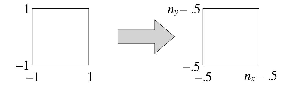
$$\begin{bmatrix} x_{\text{screen}} \\ y_{\text{screen}} \\ 1 \end{bmatrix} = \begin{bmatrix} \frac{n_x}{2} & 0 & \frac{n_x - 1}{2} \\ 0 & \frac{n_y}{2} & \frac{n_y - 1}{2} \\ 0 & 0 & 1 \end{bmatrix} \begin{bmatrix} x_{\text{canonical}} \\ y_{\text{canonical}} \\ 1 \end{bmatrix}$$
