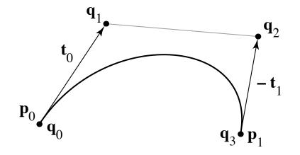
$$\begin{bmatrix} \mathbf{p}_0 \\ \mathbf{p}_1 \\ \mathbf{v}_0 \\ \mathbf{v}_1 \end{bmatrix} = \begin{bmatrix} 1 & 0 & 0 & 0 \\ 0 & 0 & 0 & 1 \\ -3 & 3 & 0 & 0 \\ 0 & 0 & -3 & 3 \end{bmatrix} \begin{bmatrix} \mathbf{q}_0 \\ \mathbf{q}_1 \\ \mathbf{q}_2 \\ \mathbf{q}_3 \end{bmatrix}$$
