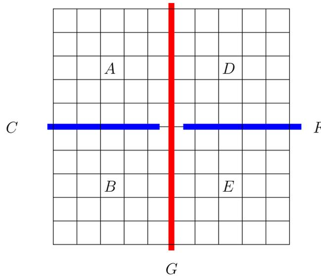
$$S = \begin{bmatrix} S_{AA} & & S_{AC} & & & & & & & S_{AG} \\ & S_{BB} & S_{BC} & & & & & & & S_{BG} \\ S_{CA} & S_{CB} & S_{CC} & & & & & & & S_{CG} \\ & & & S_{DD} & & S_{DF} & & & & S_{DG} \\ & & & & S_{EE} & S_{EF} & & & & S_{EG} \\ & & & S_{FD} & S_{FE} & S_{FF} & & & & S_{FG} \\ S_{GA} & S_{GB} & S_{GC} & S_{GD} & S_{GE} & S_{GF} & S_{GG} & & & \end{bmatrix}$$
