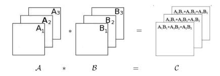
$$\begin{bmatrix} A_1 & A_3 & A_2 \\ A_2 & A_1 & A_3 \\ A_3 & A_2 & A_1 \end{bmatrix} \begin{bmatrix} B_1 \\ B_2 \\ B_3 \end{bmatrix} = \begin{bmatrix} A_1B_1 + A_3B_2 + A_2B_3 \\ A_2B_1 + A_1B_2 + A_3B_3 \\ A_3B_1 + A_2B_2 + A_1B_3 \end{bmatrix} = \begin{bmatrix} \mathcal{C}(:,:,1) \\ \mathcal{C}(:,:,2) \\ \mathcal{C}(:,:,3) \end{bmatrix}$$
