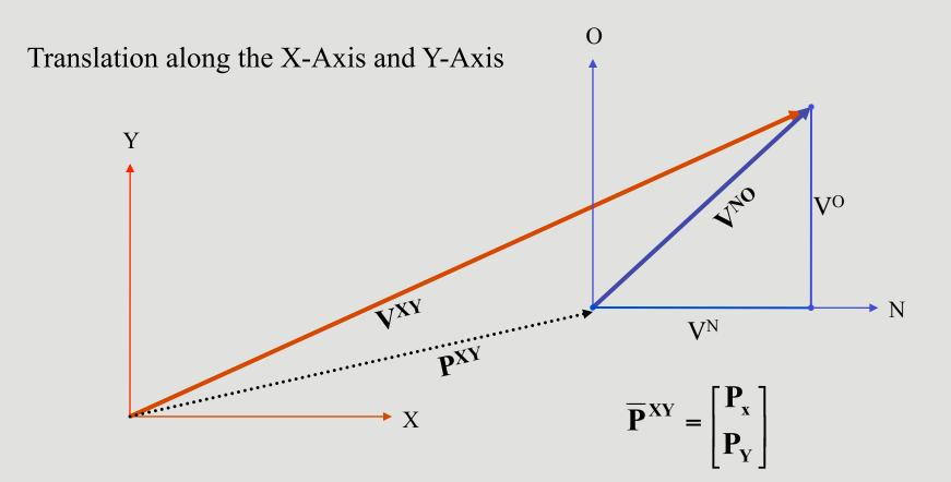
$$\overline{\mathbf{V}}^{XY} = \overline{\mathbf{P}} + \overline{\mathbf{V}}^{NO} = \begin{bmatrix} \mathbf{P}_{X} + \mathbf{V}^{N} \\ \mathbf{P}_{Y} + \mathbf{V}^{O} \end{bmatrix}$$
